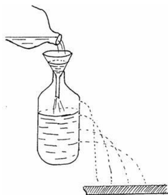
Obr. 7.4: Závislost hydrostatického tlaku na výšce hladiny
