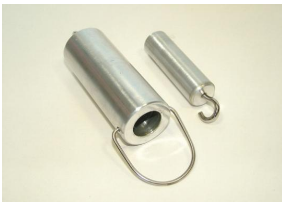
Obr. 1.8: Souprava pro demonstraci Archimédova zákona
