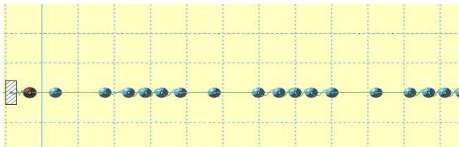
Obr. 4.11: Modelové znázornění stojatého vlnění podélného
