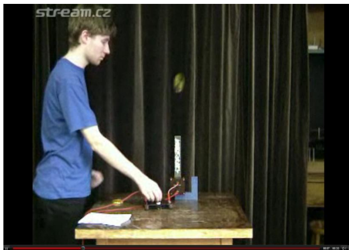
Obr. 3.9: Důsledek Lenzova zákona – magnetické dělo
